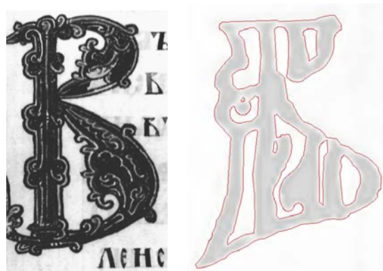
Рис. 7. Границы цветных областей (до аппроксимации – 1752 отрезка; после аппроксимации – 62 отрезка, 75 дуг)
